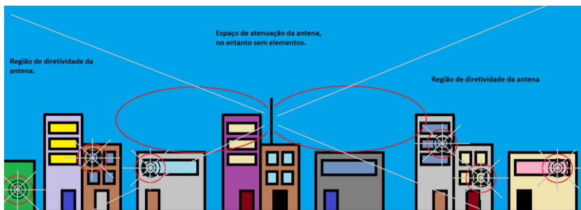
Figura 22 – Exemplo de uso de combinação de antenas diretivas e omnidirecionais que favorecem o enlace.
